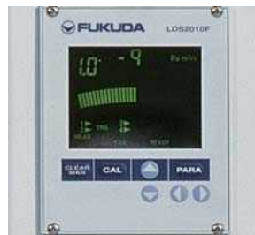
● 漏れ量表示パネル Leak amount display panel
